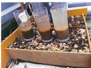
写真2 通水試験装置
